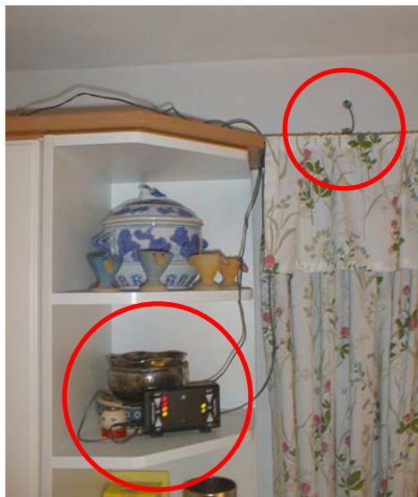
Abbildung 6: Einsatz der Lüftungsampel im Feldversuch, hier: Küche, Oberflächen-Temperaturfühler an der Außenwand
