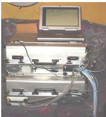
Bild 1: sampling/dosing Einheit und photoakustischer Monitor in schalldämmten Koffern
