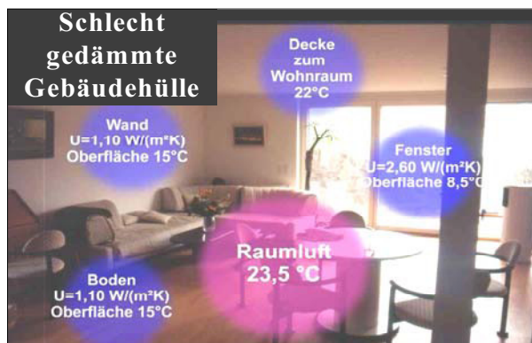
Abb. 7 Oberflächentemperaturen bei einer schlecht gedämmten Gebäudehülle
